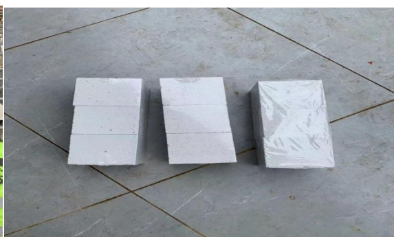
现场加砌块取样抽检
