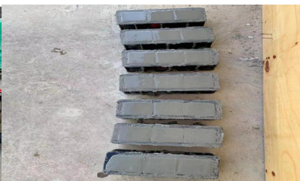
抽检现场混凝土试块
