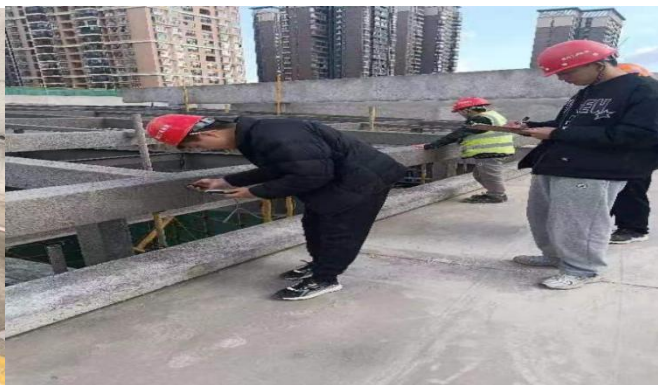
钢结构焊缝探伤检测及防火涂层厚度检测
