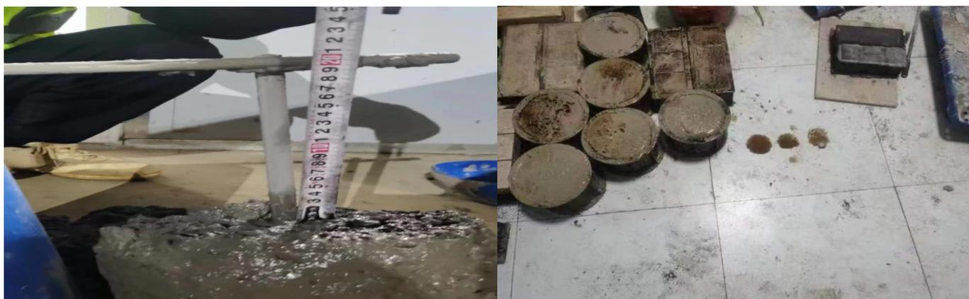
混凝土浇筑前坍落度试验及现场试块取样抽检
