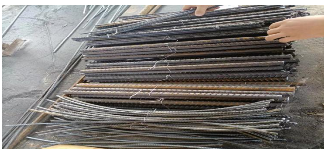
现场抽检钢筋原材复试
