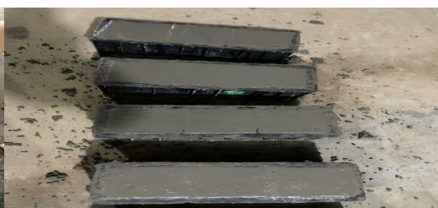
抽检混凝土现场试块取样
