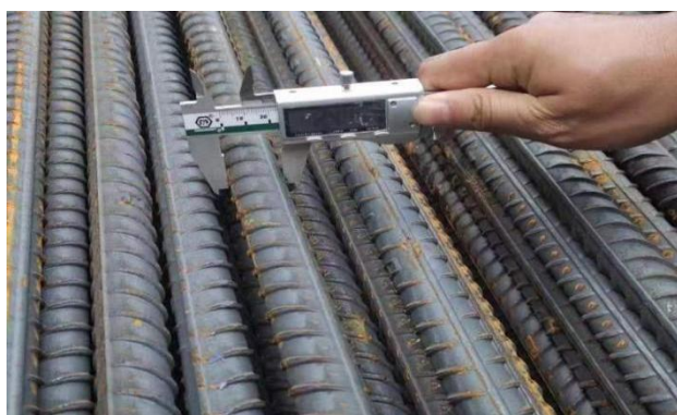
进场钢筋抽检
